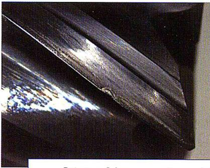
Bei einer Schruppoperation am Werkstoff 1.4571, die WEXO gegen zwei Wettbewerber durchführte, brach einer der konkurrierenden Fräser bereits nach etwa der Hälfte der Bearbeitungszeit durch den zu hohen Schnittdruck. Beim zweiten kam es nach etwa 40 Minuten zu einem Schneidkantenausbruch.
