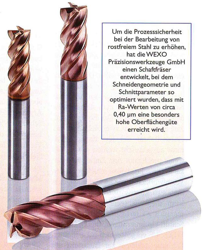
Um die Prozesssicherheit bei der Bearbeitung von rostfreiem Stahl zu erhöhen, hat die WEXO Präzisionswerkzeuge GmbH einen Schaftfräser entwickelt, bei dem Schneidengeometrie und Schnittparameter so optimiert wurden, dass mit Ra-Werten von circa 0,40 µm eine besonders hohe Oberflächengüte erreicht wird.
