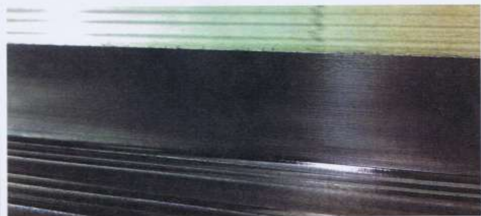
Bild 6: Bei einer Schlichtbearbeitung am Werkstoff 1.4571 konnte mit dem Wexo-Fräser eine nahezu gratfreie Werkstückkante erzeugt werden.
