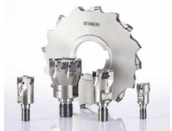
Das Tangential-Frässystem 406 wird gleich doppelt erweitert: Um Scheibenfräser und um Einschraubfräser. Die Scheibenfräser mit Durchmesser 100 mm und 125 mm und Schneidbreiten von 10 mm oder 12 mm erzielen Nuttiefen von 26 oder 34,5 mm. Bohrung und Mitnehmernut entsprechen DIN 138. Die Einschraubfräser mit Schneidkreisdurchmessern von 16, 20, 25, 32 und 40 mm sind mit einem metrischen Gewinde mit Zylinder-Plananlage und Innenkühlung
