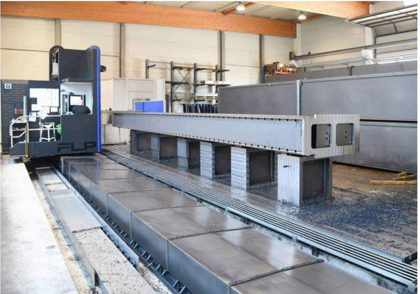
Zerspant wird in St. Willibald mit einer Fahrständerfräsmaschine „Soraluce FLP-6000“.
