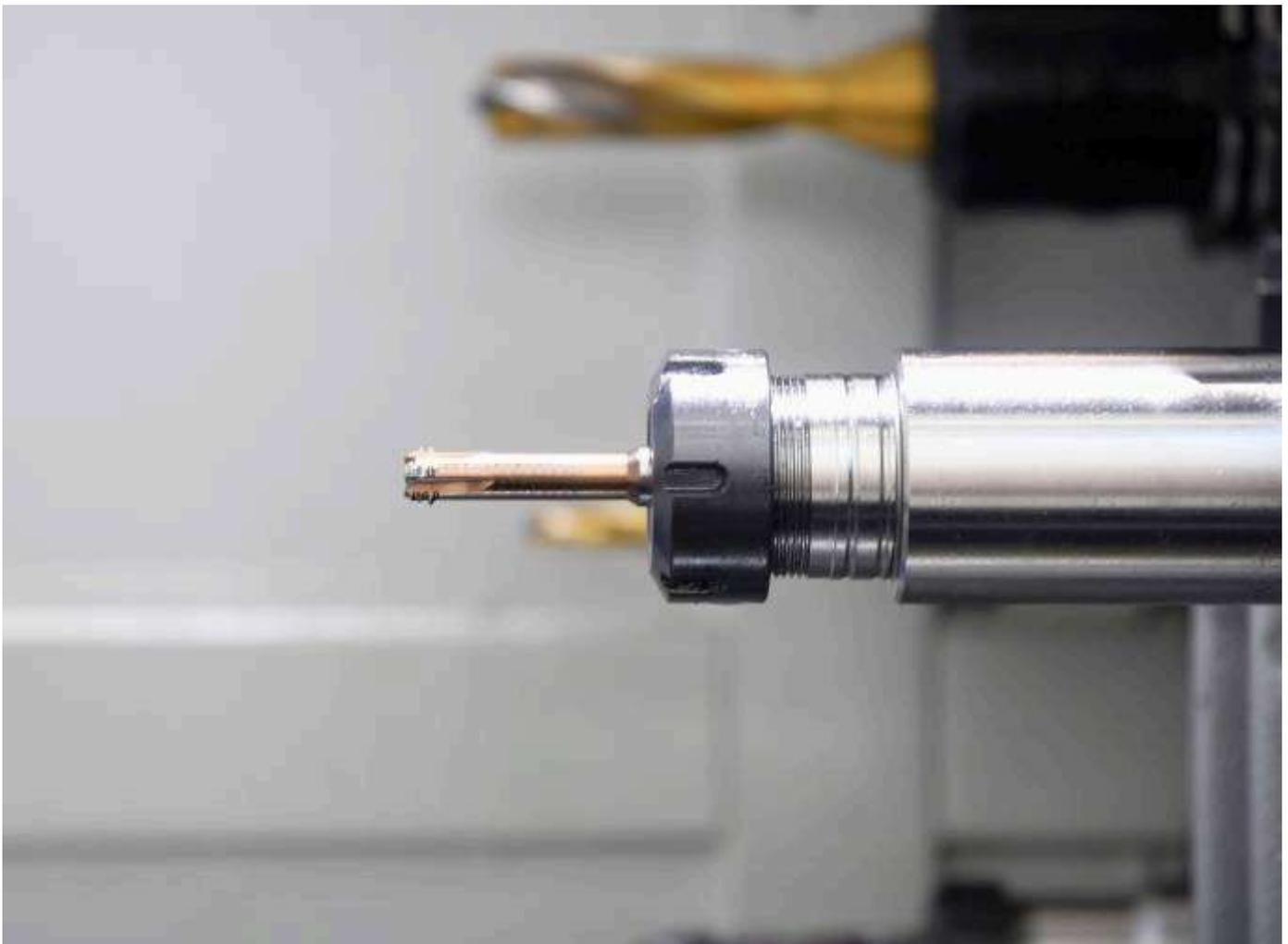
Die Zirkular-Bohrgewindefräser von Wexo bestehen aus einem AlTiN-TiSiN-beschichteten Ultrafeinstkorn-Vollhartmetall.
