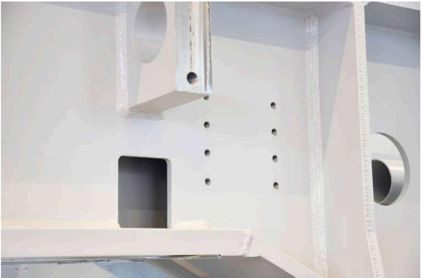
Eine Schwierigkeit beim Gewinden in Baustahl **sind die Vibrationen der überlangen Bauteile**. Dies war ausschlaggebend für die Wahl der Bohrfrästechnologie.
